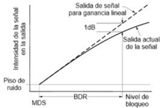
Figura 228. Rango dinámico de bloqueo. (Adaptado de ARRL (American Radio Relay League, 2020))
