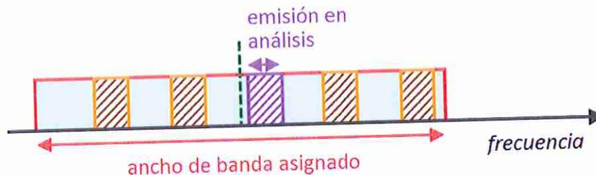
Figura 2. Ancho de banda de un "transponder" con múltiples emisiones.<sup>8</sup>
