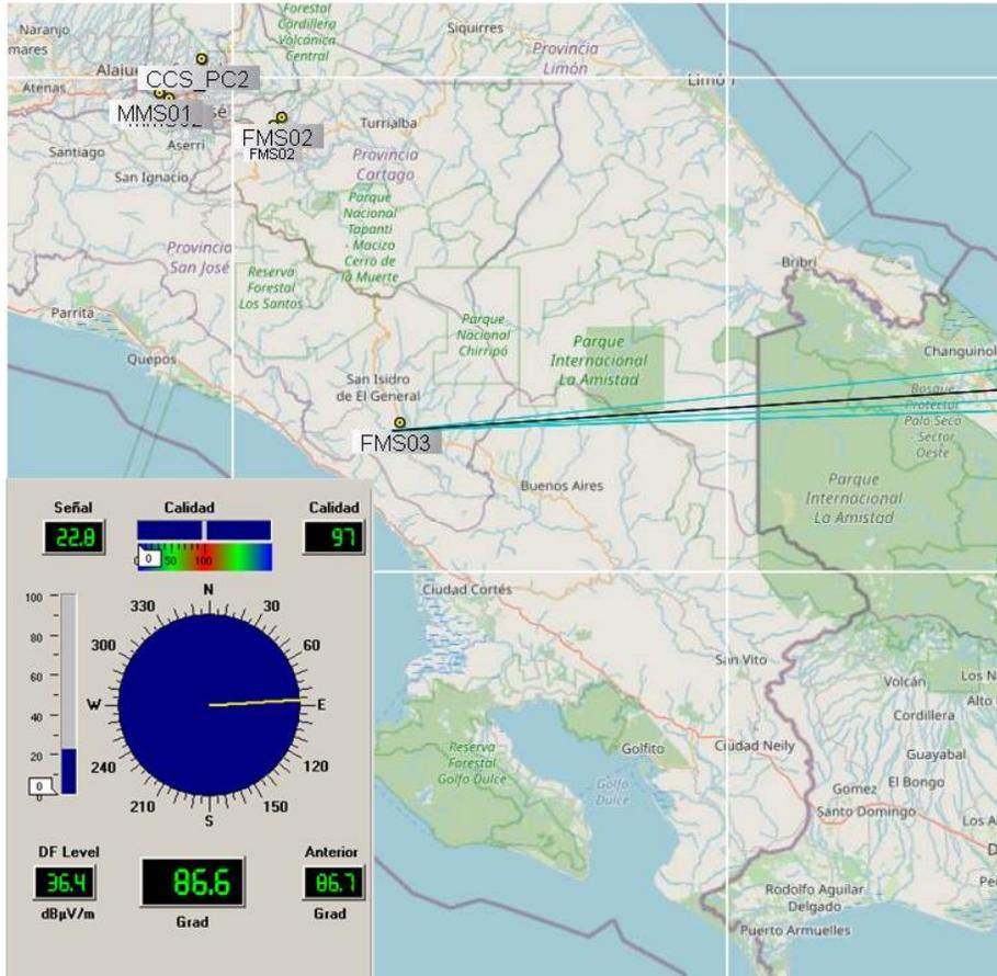
**Imagen 1.** Señales percibidas por los equipos de medición en la estación monitora de Pérez Zeledón, para el segmento de frecuencia de 758 MHz a 773 MHz.
