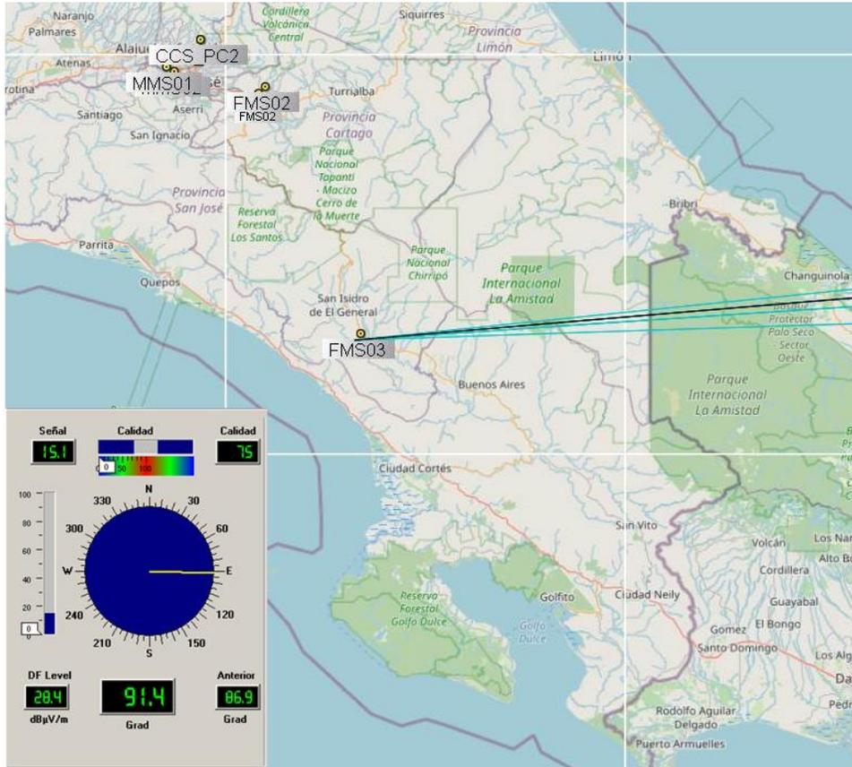
**Imagen 2.** Señales percibidas por los equipos de medición en la estación monitora de Pérez Zeledón, para el segmento de frecuencia de 773 MHz a 783 MHz.
